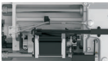
Dois motores de passo, para corte de fios e retrocesso automático
