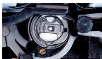
Mecanismo de corte de fios inovador através de facas redondas duplas, reduzindo efetivamente defeitos e manutenções e deixando pontas mais curtas do que sistemas convencionais
