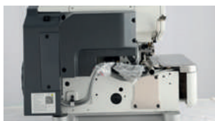
Corte de linhas automático através de motor de elétrico
